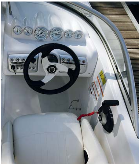
Přístroje jsou zapuštěny velmi mělko a nejsou přetaženy žádným krytem, takže jsou příznány jejich tvary, které pod tenkou vrstvou vytvářejí zajímavý „buřtový“ efekt.
