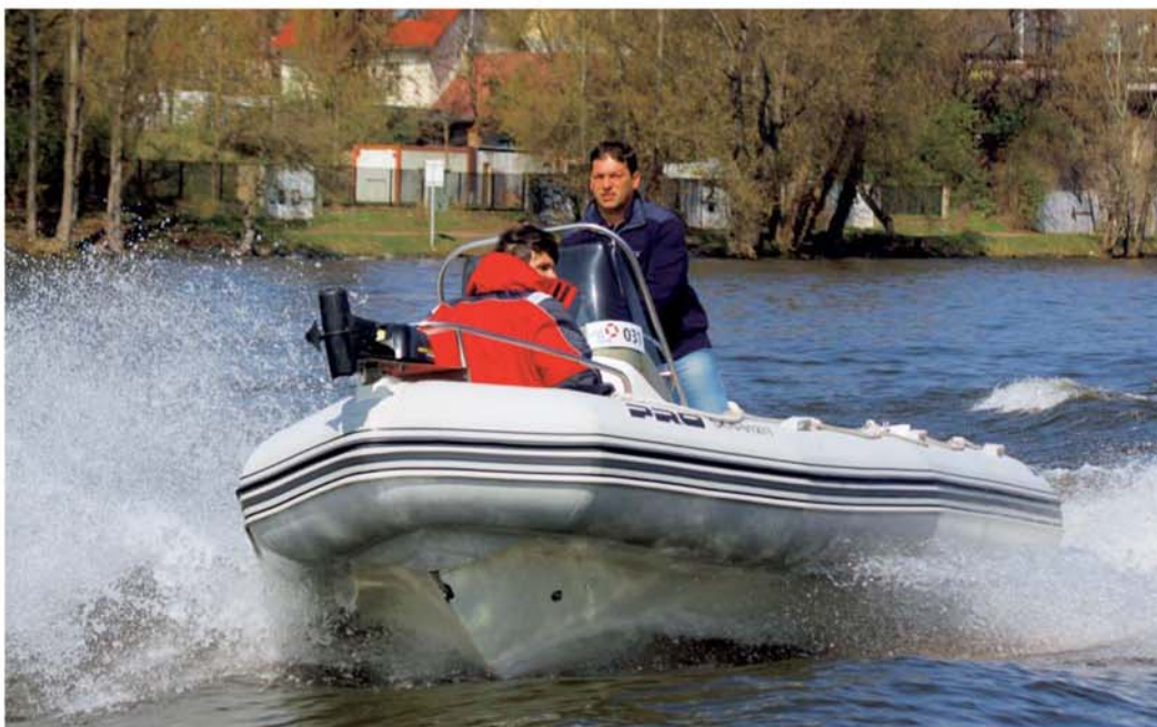
Zodiac Pro Open 550 hladce naskočil do sklužu při 3 000 ot./min, maximální rychlosti 39 uzlů dosáhl při 5 000 ot./min.
