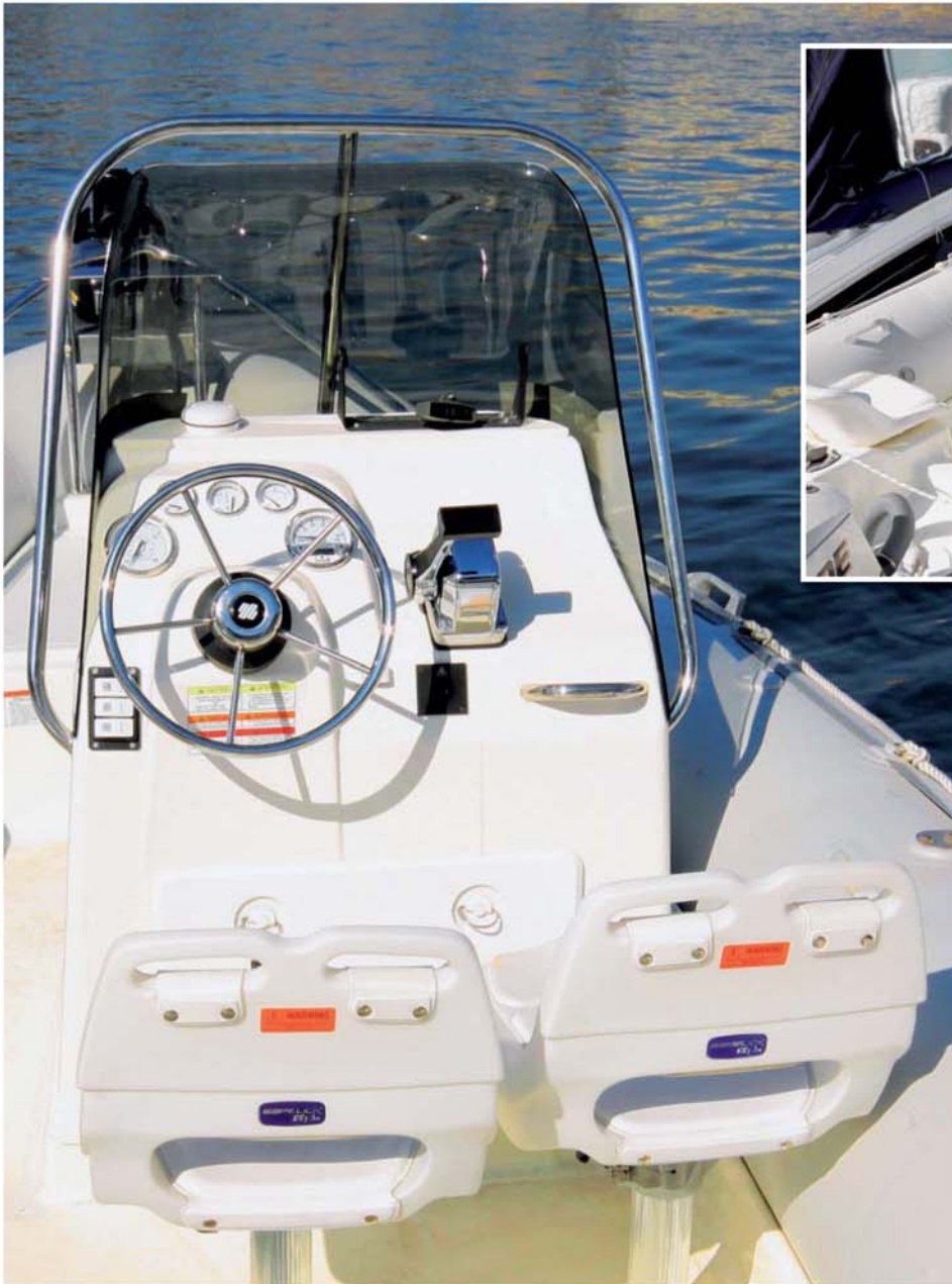
Kokpitu dominuje sklápěcí centrální konzola se dvěma křesly a bohatým přístrojovým vybavením.
