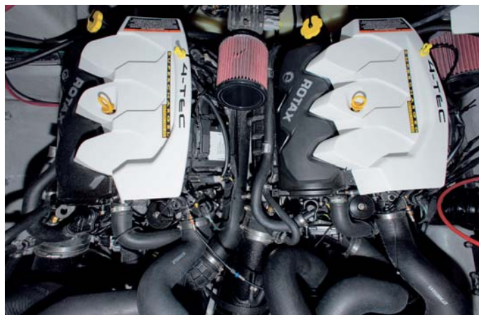
Challenger pohánějí dva jetové motory Rotax 4 E-Tec o výkonu 2x 255 koní.
