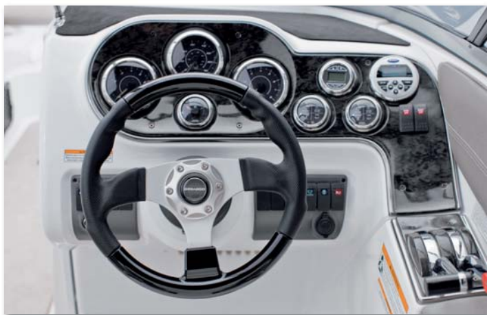
Na přehledné palubní desce najdeme multifunkční digitální otáčkoměr a rychloměr.
