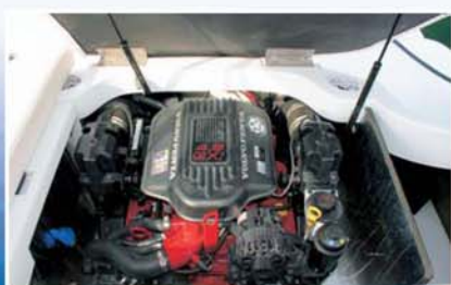
Testovaný člun byl vybaven motorem Volvo Penta 4.3 GXI o výkonu 225 koní.
