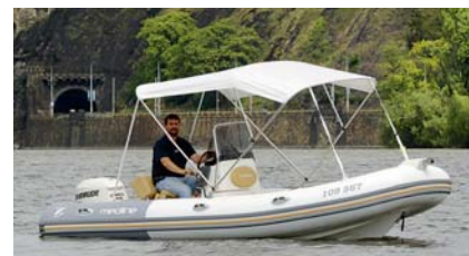
Z volitelného příslušenství zde byla především skládací stříška bimini, jejíž pevná konstrukce dovoluje posádce být ve stínu i při plavbě.
