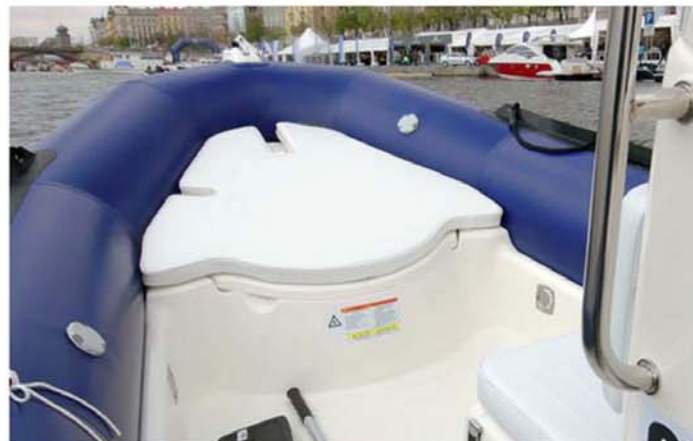
Na přídi je ve standardní výbavě schránka s vyjímatelným skladovacím boxem vhodná i k sezení.
