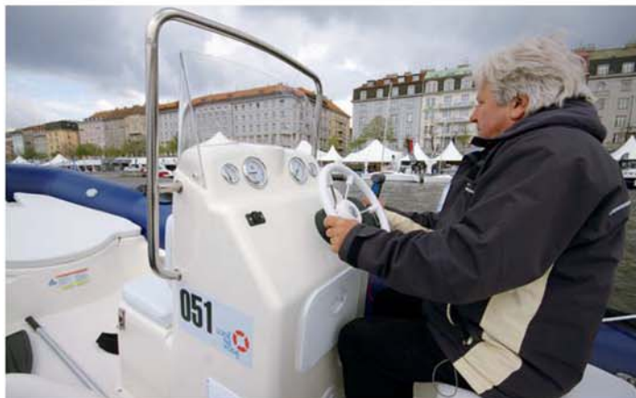
Středová konzola s ochranným sklem, volantem, budíky motoru, pákou plynu, vnitřním úložným prostorem, dvojsedačkou a další sedačkou vpředu
