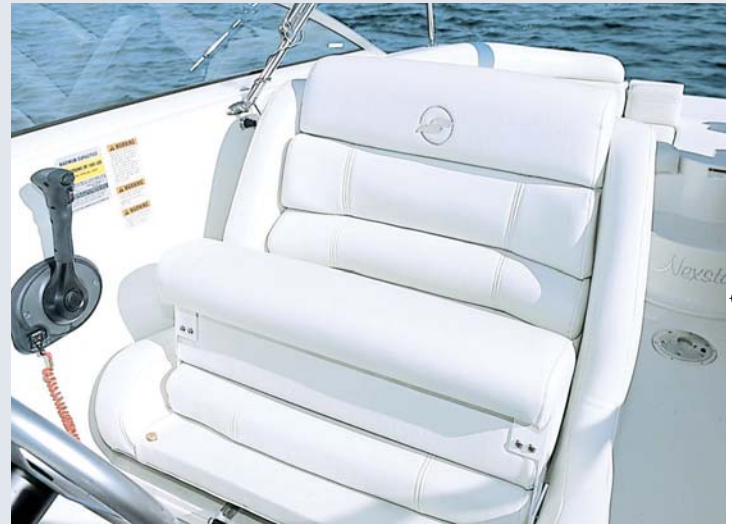
Ergonomicky tvarovaná sedačka řidiče umožňuje řízení jak vsedě, tak vestoje.
