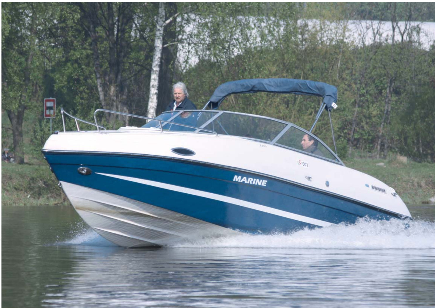
Typický tvar trupu do hlubokého „V“ umožňuje dynamickou a pohodlnou jízdu jak na klidné hladině řek nebo jezer, tak na vlnách moře.
