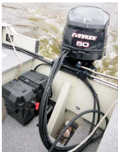
Testovaná loď byla osazena řadovým dvouválcovým motorem Evinrude E-TEC s dlouhou nohou o výkonu 50 koní.
