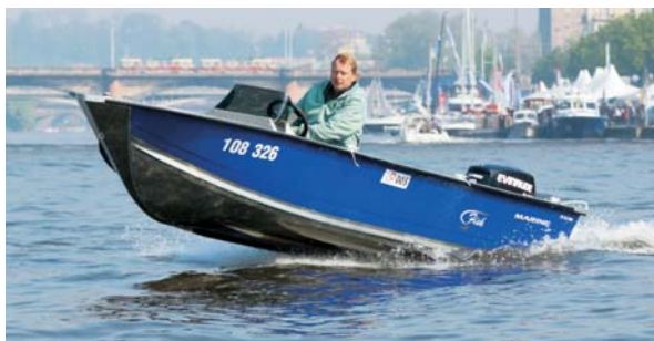
Trup do hlubokého „V“, vysoké boky a plochá záď zajišťují klidnou, bezpečnou a stabilní jízdu i po zvlněné vodní hladině.
