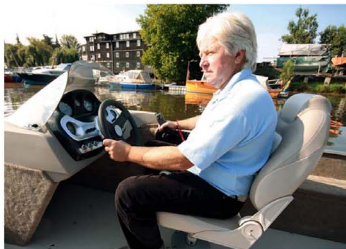
Na palubní desce je osazen tachometr, rychloměr, voltmetr, trim a stav paliva.
