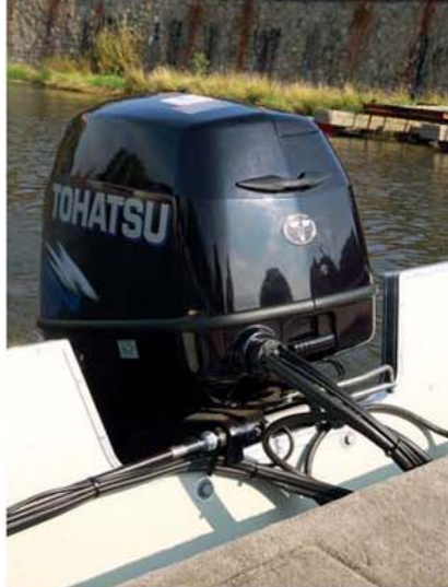
Testovaná loď byla vybavena dvoutaktním motorem Tohatsu PLDI o výkonu 90 koní.
