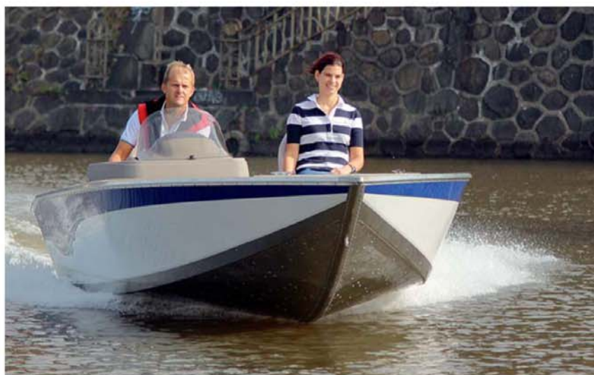
Tvar trupu do hlubokého „V“, vysoké boky a plochá záď zajišťují stabilitu a hladkou jízdu i na hrubší vodě.
