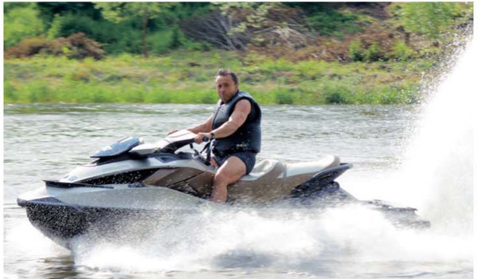
Dalším převratným systémem je brzda iBR (inteligentní systém brzda a obrácený chod), která zastaví skútr na poloviční vzdálenosti, než kdyby se nepoužila.
