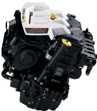
Sea-Doo GTX iS 260 Limited je vybaven přeplňovaným čtyřtákním motorem Rotax SOHC o maximálním výkonu 260 koní a objemu 1 494 ccm s vnitřním chlazením.
