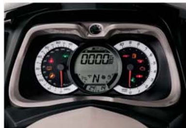
Na prostředním digitálním displeji si můžete navolit, co chcete, aby se zobrazovalo. Například rychlost díky velkým číslicím přečtete i při jízdě na maximum.
