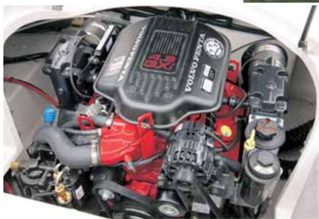
V prostoru pod zadní sedačkou je uložen motor, v případě testované lodě Volvo Penta 4.3 GXi o výkonu 225 koní.
