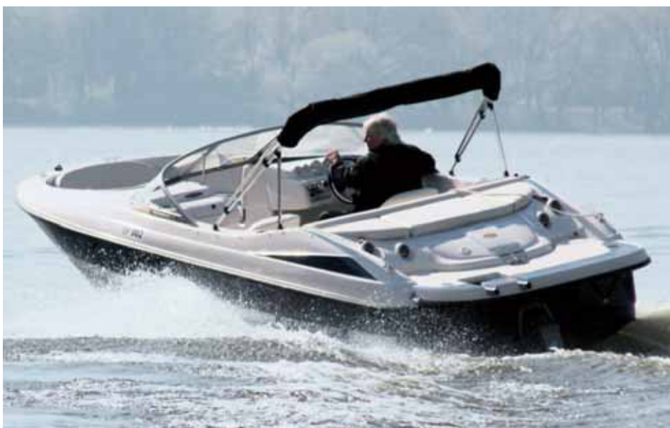
Reverzní bočnice zlepšují odstřík vody, a zvyšují tak manévrovatelnost i ve velkých rychlostech.
