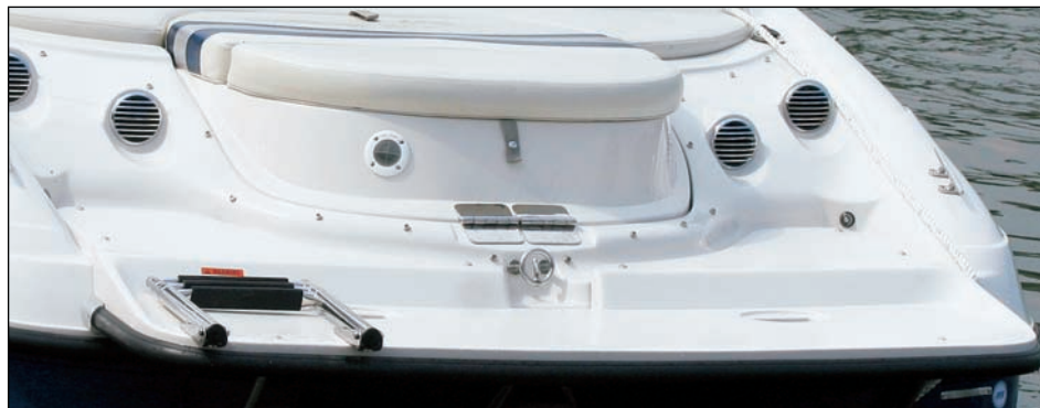
Člun je zakončen laminátovou koupací plošinou opatřenou nerezovým žebříkem pro vstup do vody.
